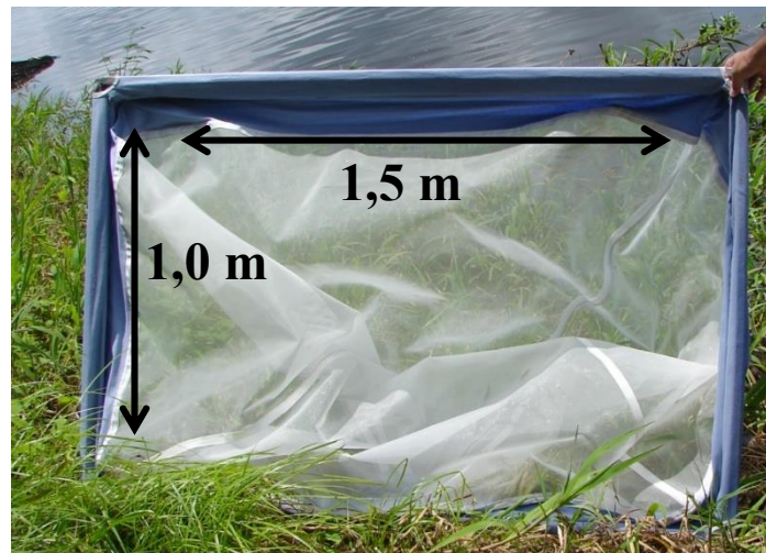
Figura 2 - Peneirão utilizado nas coletas de larvas e juvenis de peixes em bancos de macrófitas aquáticas.
