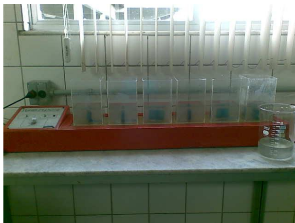
FIGURA 16 – Jar test utilizado para estudo pertencente ao laboratório da COSANPA.
