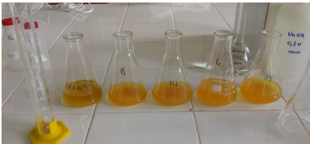
Figura 4- Determinação do cloreto em laboratório
