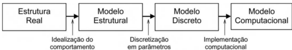
Figura 31 - Quatro níveis de abstração referentes a uma estrutura na análise estrutural
