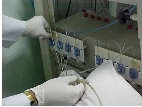
Figura 5: Conexão dos transdutores à bomba de infusão.
