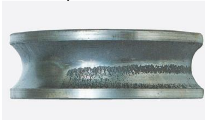
Figura 36. Defeito causado por desalinhamento em anel interno de rolamento.
