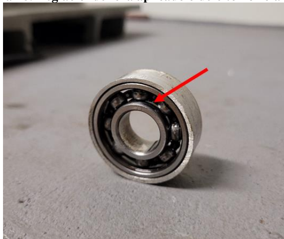
Figura 78. Região onde fora aplicado o defeito no rolamento.
