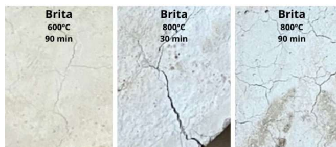
Figura 61: Corpos de prova de brita e seixo aquecidos a 600° C e 800° C, apresentando fissuras
