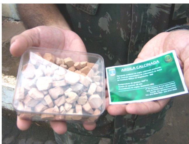
Figura 4.2: Argila Calcinada produzida pelo Instituto Militar de Engenharia (IME) (CABRAL, 2005).
