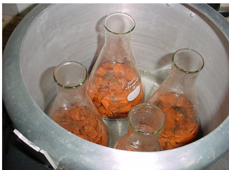
Figura 5.1: Ensaio de Perda de Massa após Fervura (BATISTA, op. cit)
