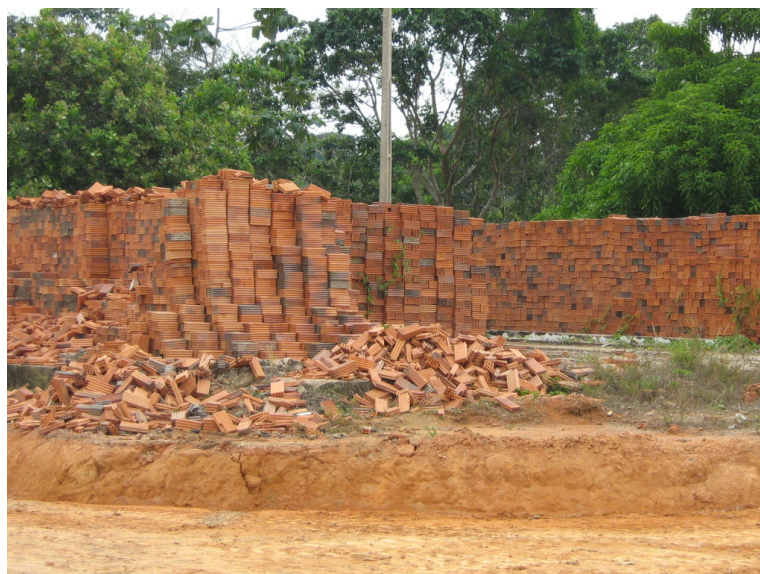
Figura 6.3: Excesso de quebra dos blocos de Argila Calcinada
