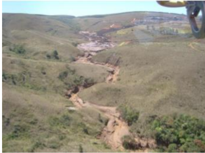
Figura 20 - Calha do curso d'água (vale encaixado) afluente do córrego do Silva a jusante da B3, afetado pelo rompimento da B1.
