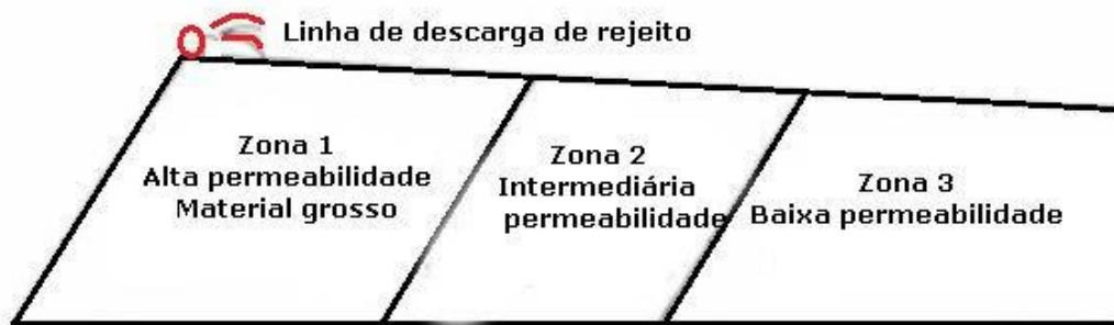
Figura 1 - Modelo teórico de variação da condutividade hidráulica em depósito de rejeitos.
