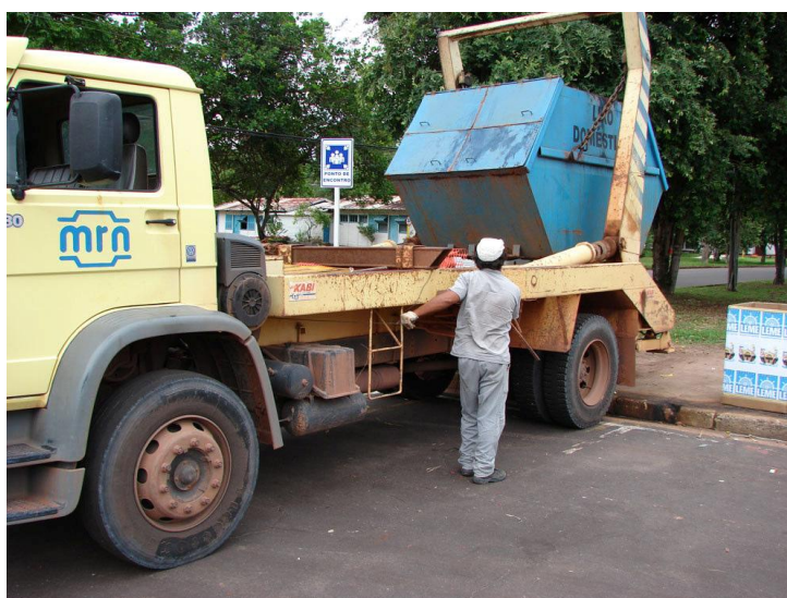
Figura 5.3-1. Operação do caminhão Brook para colocação da caçamba. Fonte: MRN
