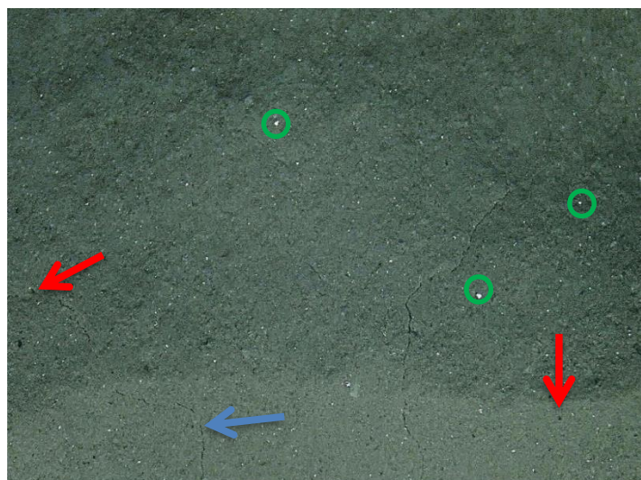
Figura 25 – Pasta Geopolimérica com 55% de EAF com 7 dias de cura. (a) Macroestrutura; (b) Microestrutura com aumento de 10x.
