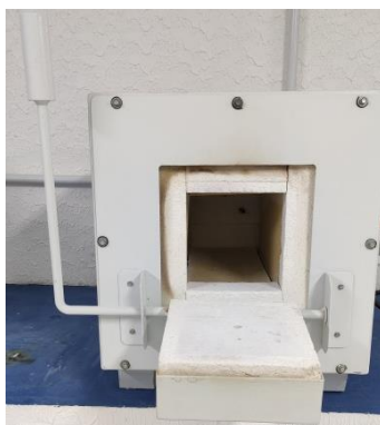
Figura 17 - Forno mufla utilizado na exposição térmica das pastas e argamassas geopoliméricas
