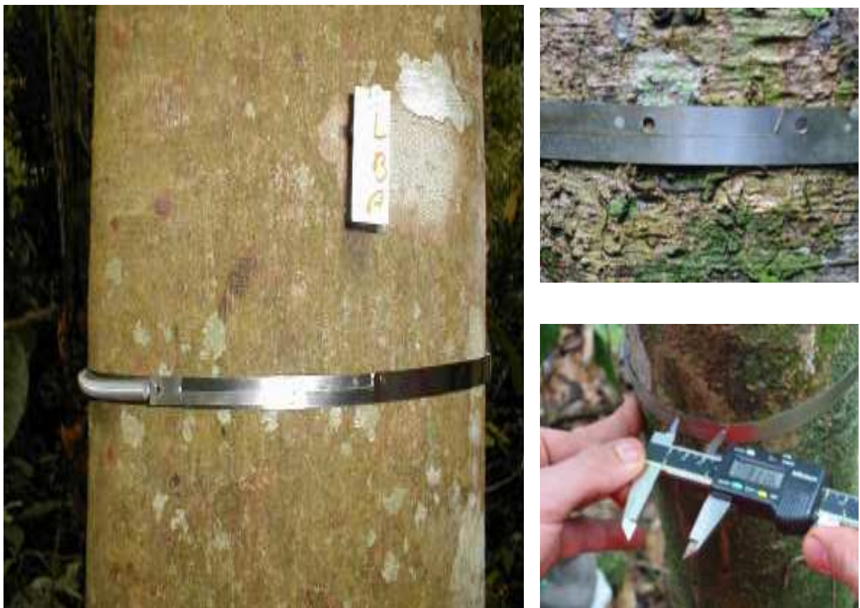
Fig. 03 – Cintas dendométricas e a medida com o paquímetro digital.
