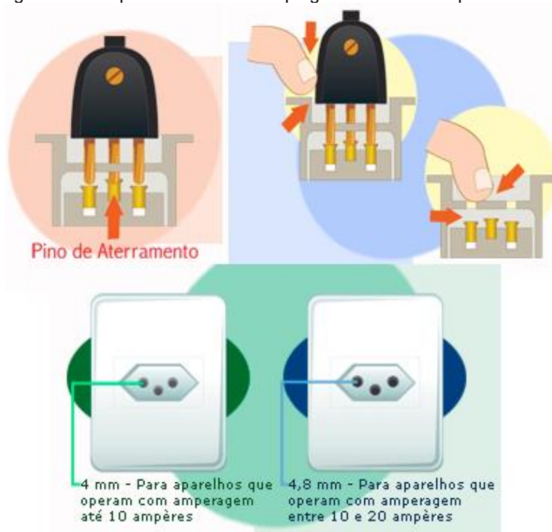
Figura 4-4 – O padrão brasileiro de plugues e tomadas a partir de 2011
