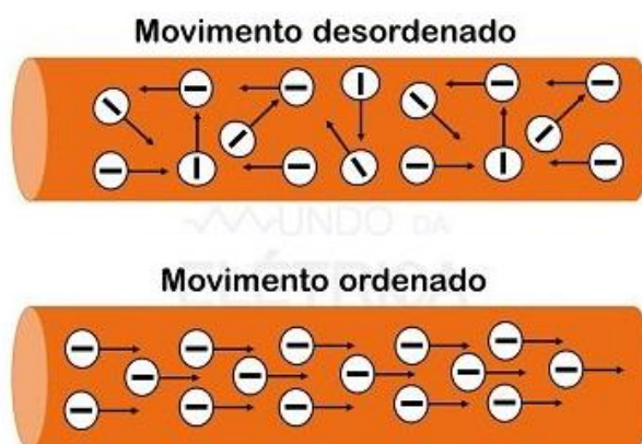
Figura 2-3 – Elétrons em um fio se movendo de forma desordenada e de forma ordenada
