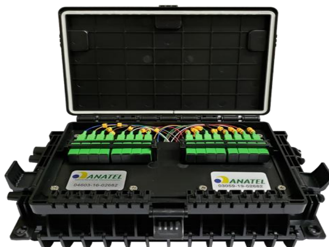
Figura 5. Caixa de Atendimento Óptico FTTH P/ Cordoalha C/ Splitter 1x16 APC.
