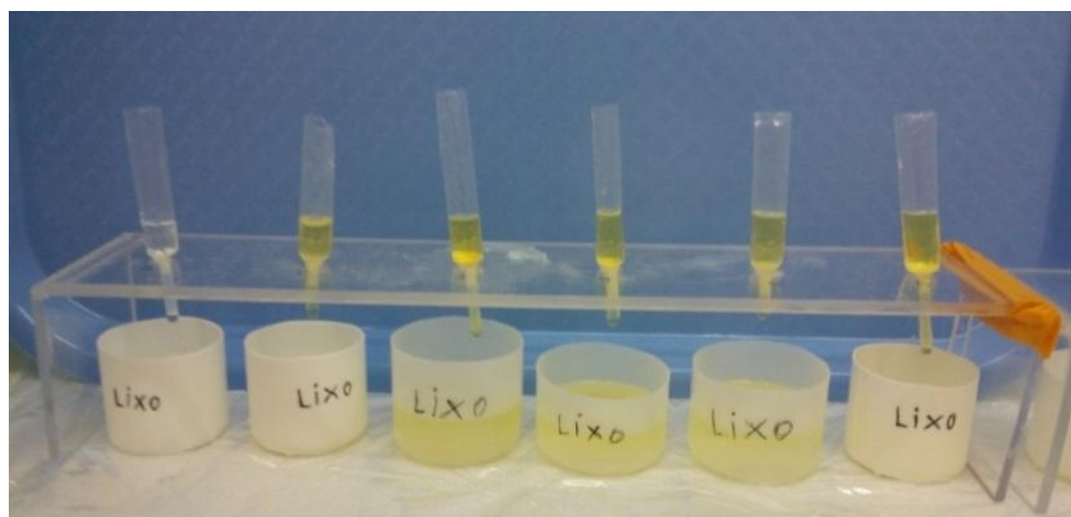
Figura 12 - Cromatografia de troca iônica em colunas de teflon.
