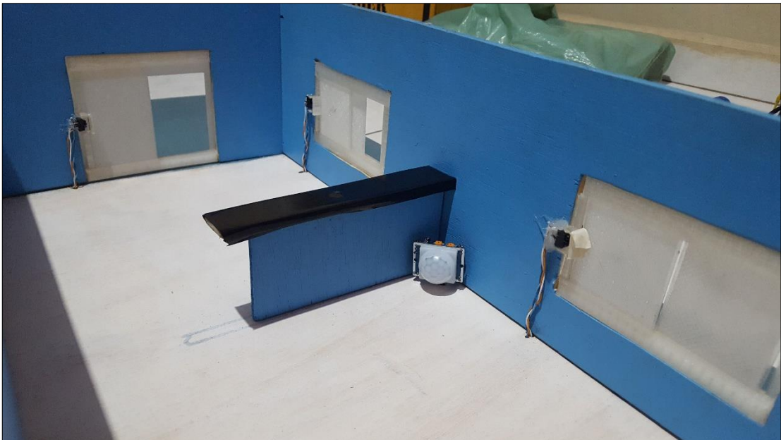
Figura 30 - Implementação do Sensor PIR
