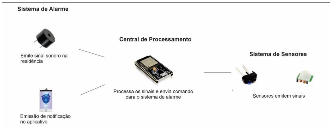
Figura 20 - Sistema de Alarme
