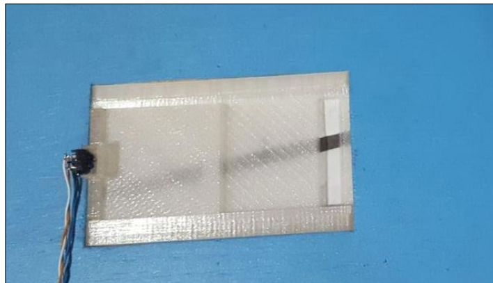
Figura 28 - Implementação do sensor
