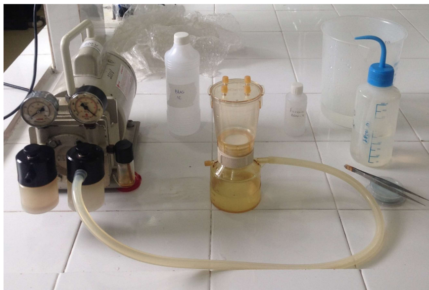
Figura 11 - Sistema de filtração utilizado durante o procedimento de preparo das amostras.
