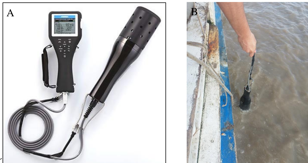
Figura 5. Sonda multiparâmetros HORIBA U-50 (A) e sua utilização no momento da coleta dos dados dos parâmetros físico-químicos (B). Fonte: (A) Horiba Group e (B) da autora.
