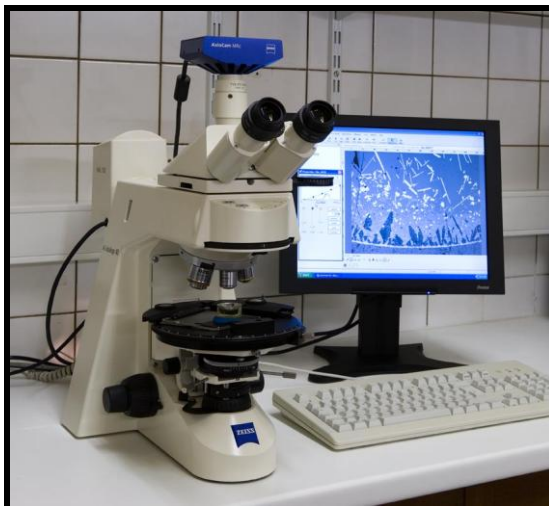
FIGURA 6 – Microscópio petrográfico, modelo axioskop 40, utilizado para realização da identificação mineralógica e obtenção de fotomicrografias.
