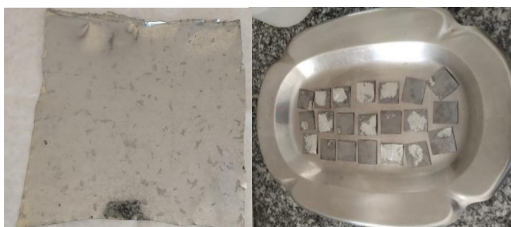
Figura 8 - Corpos de provas preparados para o ensaio de corrosão.
