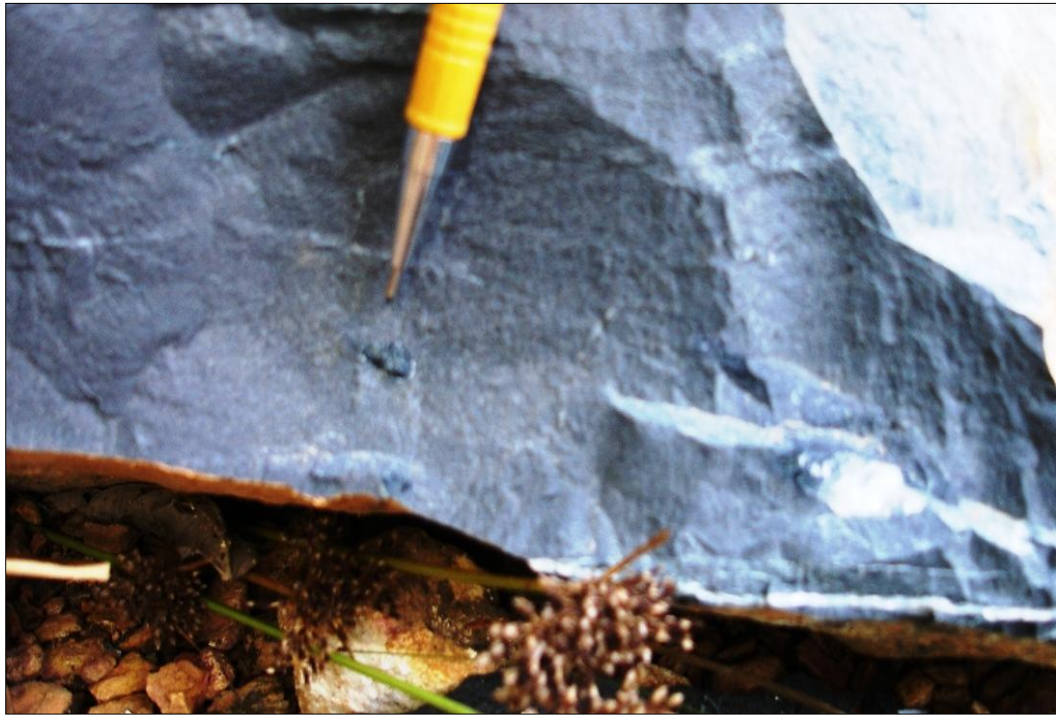
Figura 7.11 - Detalhe do basalto maciço, com algumas amígdalas com dimensões aproximadamente 1 cm (Ponto 2006/TU-01).
