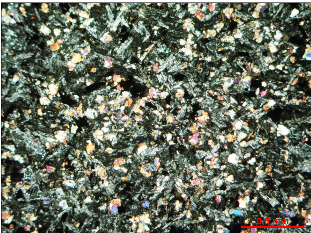
Figura 7.4 - Fotomicrografia mostrando aspecto geral da textura intergranular do basalto (Amostra 06/TU-02).
