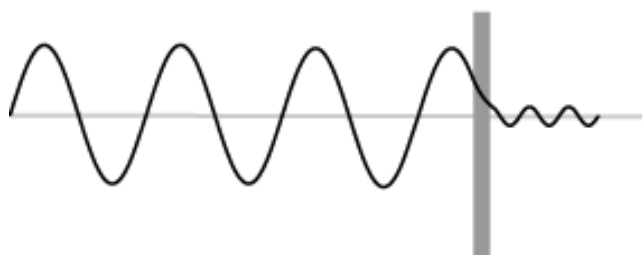
Figura 1.6: Representação do tunelamento quântico de um elétron através de uma barreira de potencial [40].
