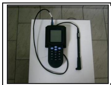
Figura 8: Multiparâmetro com eletrodo de medir oxigênio dissolvido.
