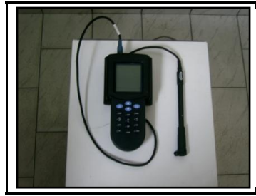
Figura 7: Multiparâmetro com eletródo de análise de pH.
