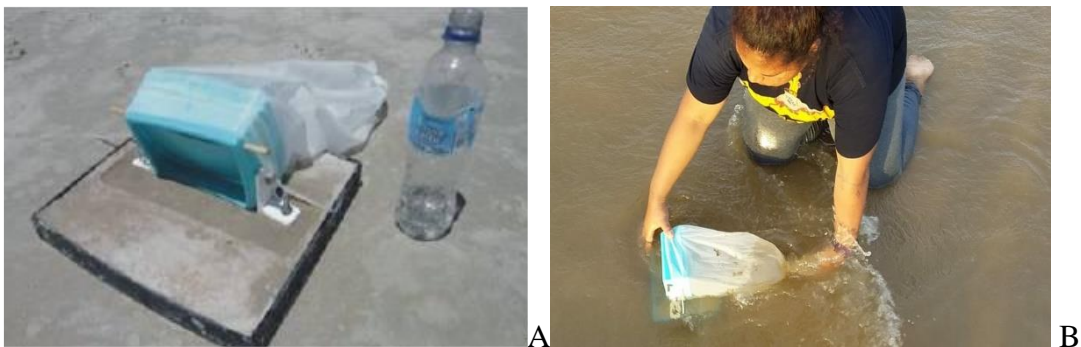
Figura 10 – Trap de espraçamento (A). Amostragem de sedimentos com trap de espraçamento (B). Fotografias tiradas em 06/09/2019.
