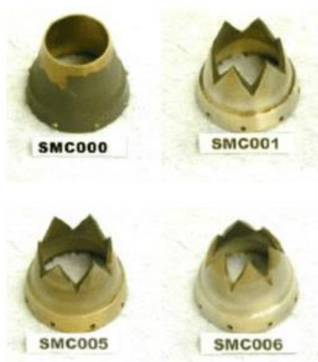
Figura 4. SMC000 (Round): 0 dente, 0° de penetração; SMC001 (Nom): 6 dentes, 5° de penetração; SMC005 (NoPen): 6 dentes, 0° de penetração; SMC006 (DeepPen): 6 dentes, 18,2° de penetração.
