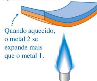
(b) A lâmina se curva quando sua temperatura é elevada.
