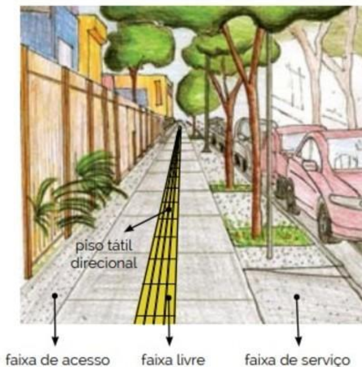
Figura 11 - Imagem representando as dimensões de uma calçada adequada
