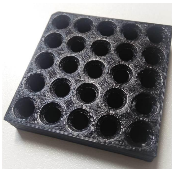
FIGURA 12 - Fotografia da placa de spot test fabricado por impressão 3D em PLA com acabamento.
