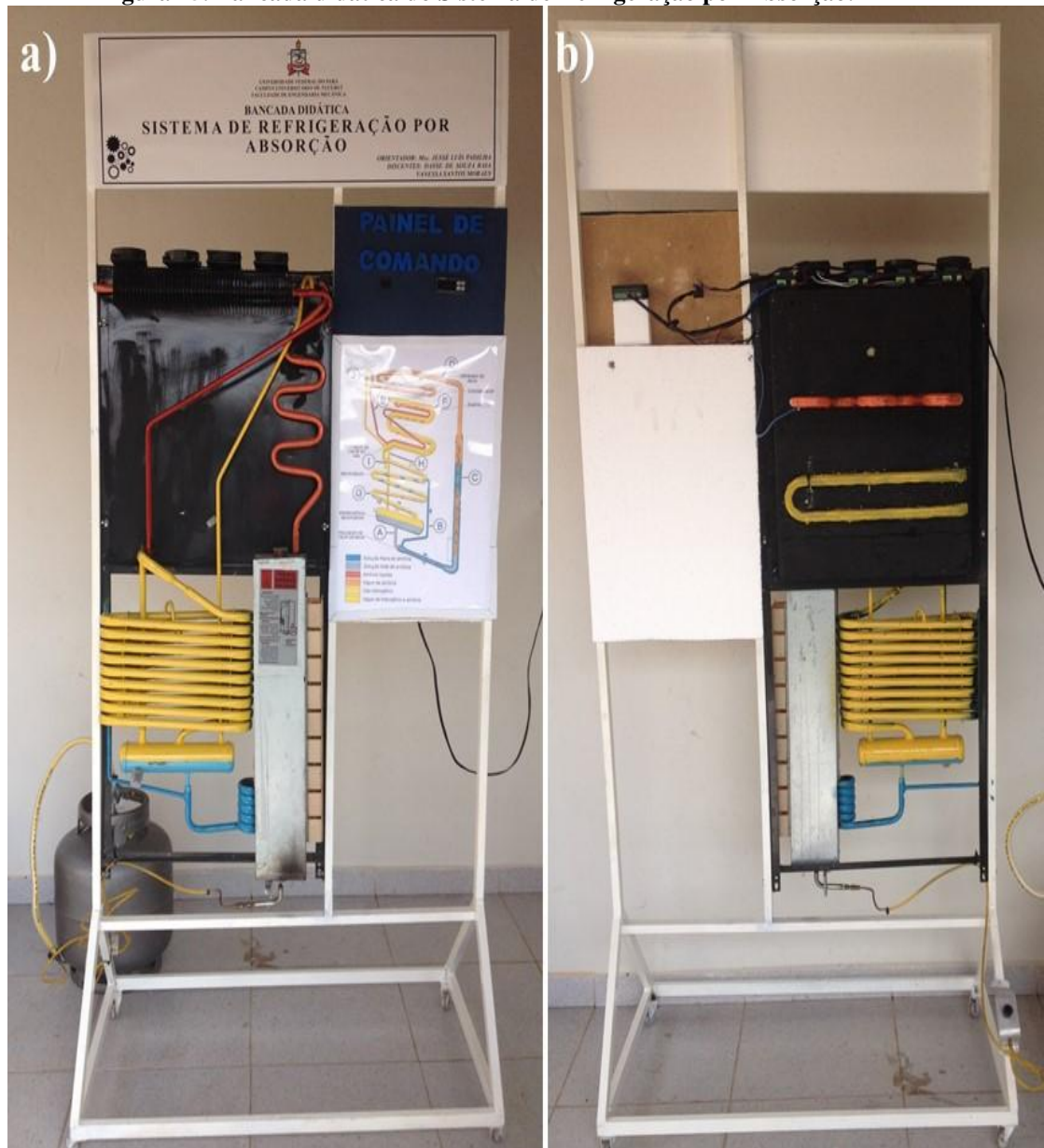
Figura 25. Bancada didática do Sistema de Refrigeração por Absorção.
