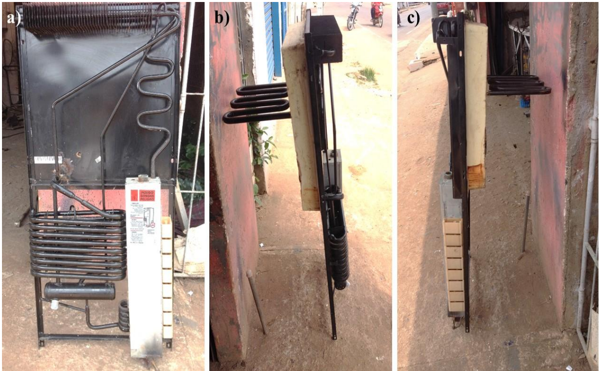
Figura 17. Sistema de Absorção do Refrigerador a) Vista dianteira; b) Lateral esquerda; c) Lateral direita.
