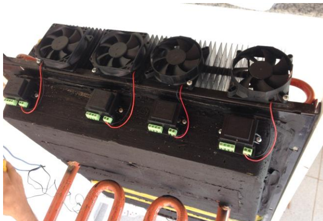
Figura 22. Montagem do sistema de ventilação forçada.
