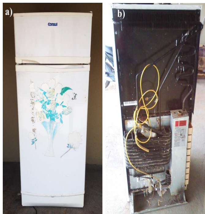
Figura 15. Refrigerador Consul a) Vista Dianteira; b) Vista traseira.
