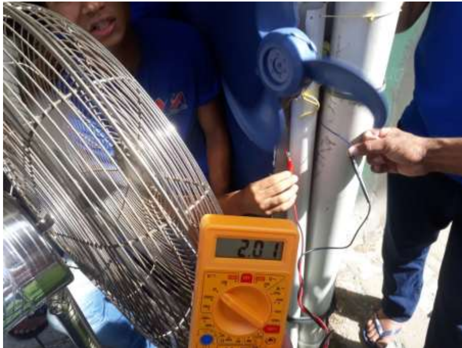
Figura 12: Multímetro registrando 2.01V, voltagem máxima produzida por esse aerogerador de baixo custo
