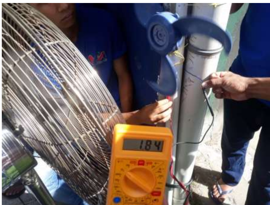
Figura 11: Multímetro registrando a passagem de 1.84V no circuito do aerogerador
