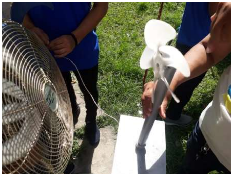
Figura 9: Aerogerador de baixo custo, e na esquerda ventilador para simular o vento
