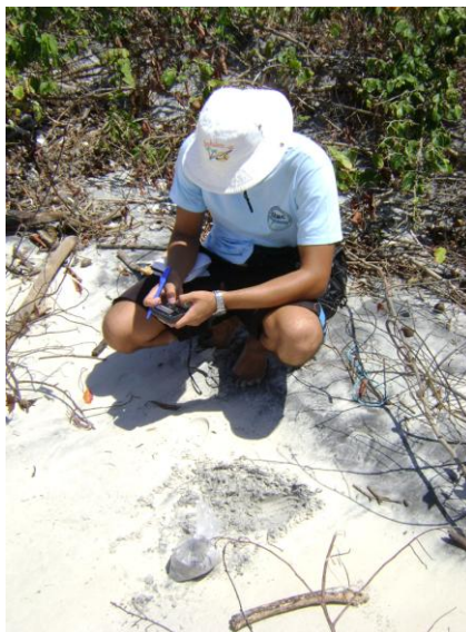
Figura 11 - Coleta de amostra de sedimentos superficiais sendo georreferenciados com auxílio de GPS.
