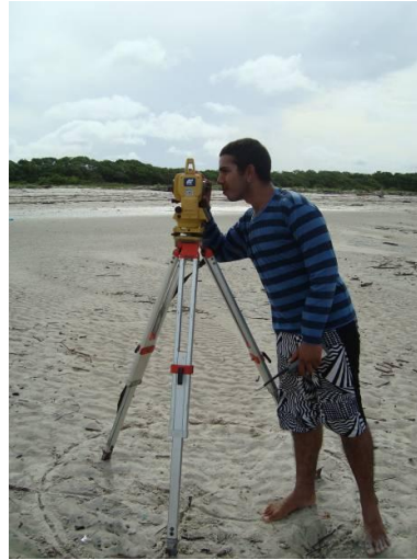
Figura 10 - Levantamento topográfico através da visada de pontos de coleta pelo do método Estação Total, ponta de Mariteua, Março de 2010.
