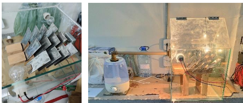
Figura 3 – Disposição dos cp's no equipamento
