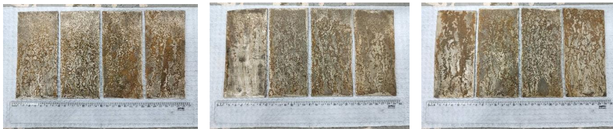
Figura 6 – Cp's após a limpeza mecânica
