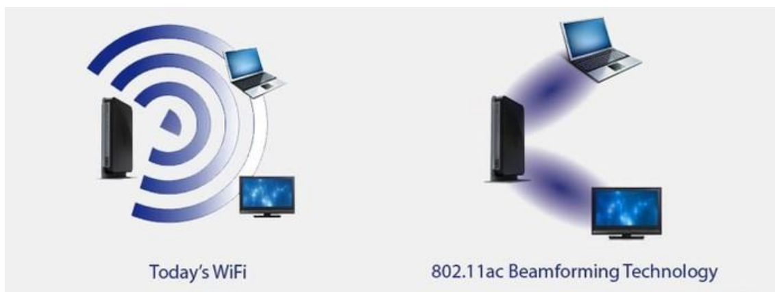
Figura 1: Emissão de sinal dos pontos de acesso atuais vs pontos de acesso com beamforming Fonte: HOFFMAN (2015)
