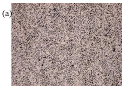
Figura 20 - Microestruturas do aço ASTM A131 em diferentes condições. (a) Como recebido; (b) Normalizado; (c) Têmpera. (d) Têmpera seguido do Revenido. (e) Recozimento Pleno. Aumento de 100x
