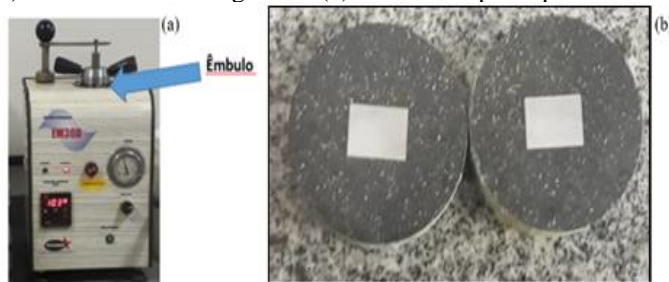
Figura 13 – (a) Embutidora metalográfica. (b) Amostras após o processo de embutimento.
