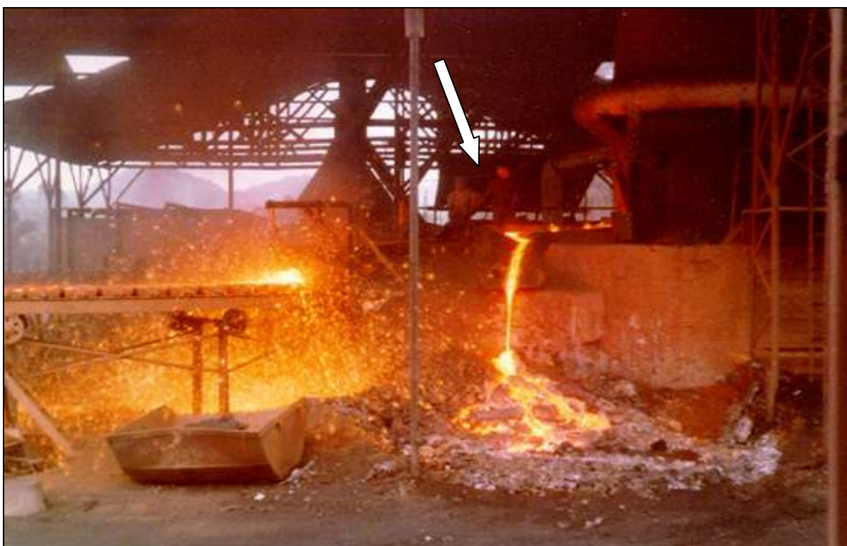
Figura 04: Processo de metalurgia do concentrado de chumbo, com deposição da escória diretamente sobre o pátio. Mina de Panelas. Detalhe para a seta, indicando pessoal exposto aos vapores e fumos emanados pela escória a alta temperatura, provavelmente, prejudiciais à saúde humana. A fotografia demonstra a falta de controles ambientais na disposição das escórias e os perigos ocupacionais ocasionados aos trabalhadores (Fonte: LICCARDO, 2007).
