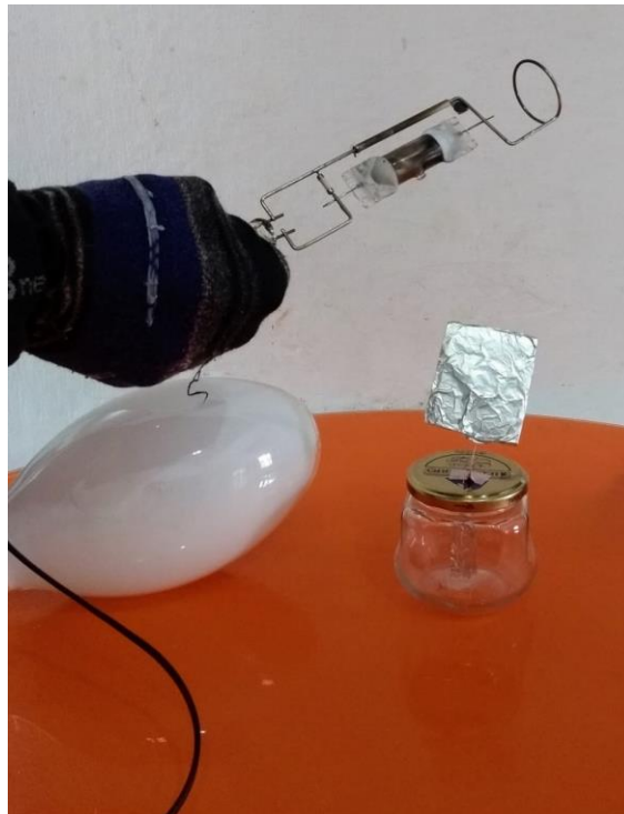
Figura 22 – Experimento do Efeito Fotoelétrico através do eletroscópio caseiro
