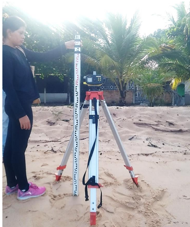
Figura 3 - Nível topográfico e régua escalonada utilizados nas medições topográficas em campo (Foto: Autor).
