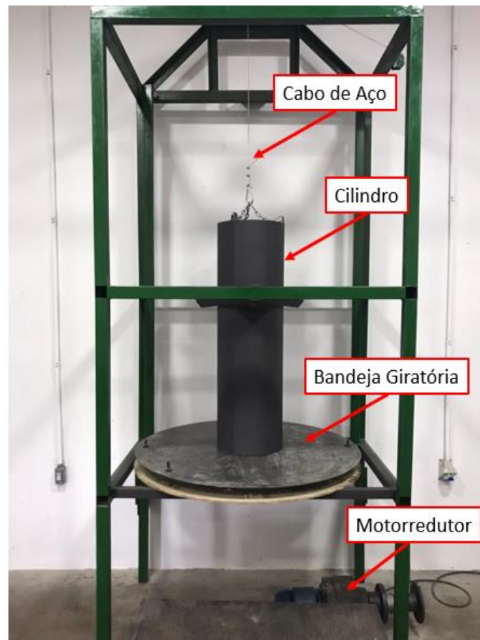
Figura 18 - Sistema de medição do ângulo de repouso.
