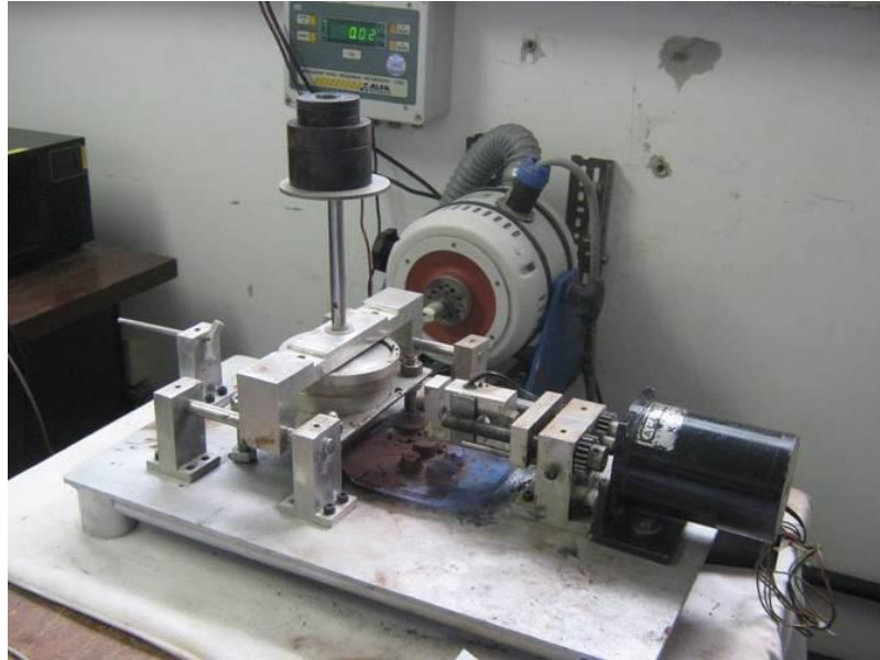
Figura 22 - Célula Jenike empregada ao ensaio de atrito entre partículas.
