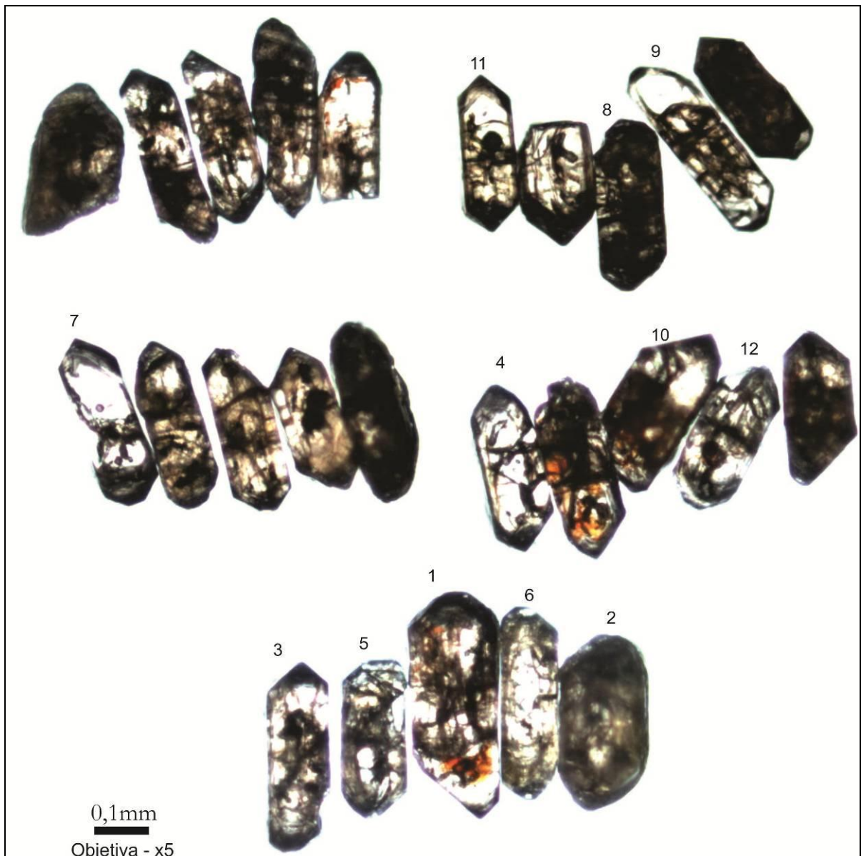
Figura 21 - Cristais de zircão da amostra MV-69 entre as granulometrias 0,075 mm e 0,180 mm vistos ao aumento de 5x. A numeração dos cristais representa o filamento de rênio em que os mesmos foram analisados.
