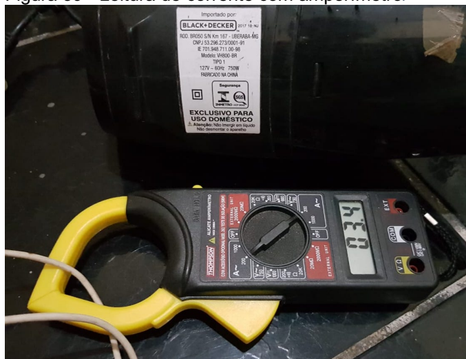
Figura 39 - Leitura de corrente com amperímetro.
