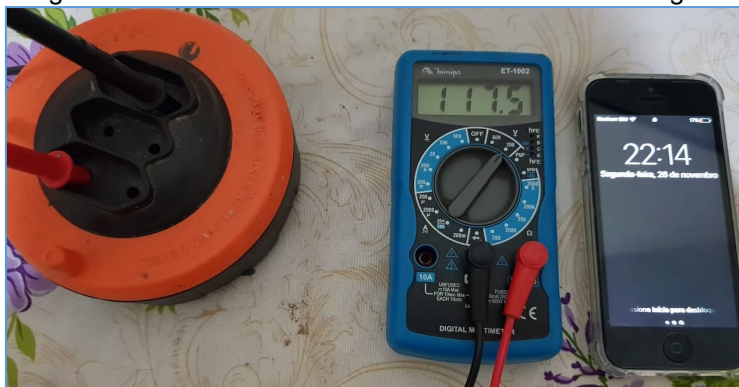
Figura 40 - Leitura da tensão usando um multímetro digital.
