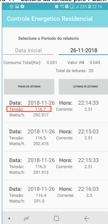
Figura 41 - Leitura da tensão pelo PZEM-004T.
