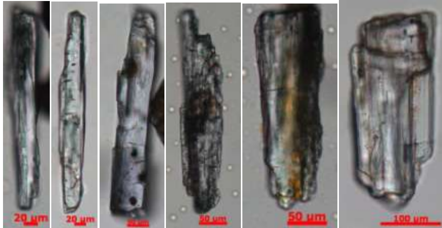
Figura 23 - Microfotografia dos grãos de silimanita identificados nos sedimentos estudados, destacando grãos preferencialmente prismáticos e alongados.
