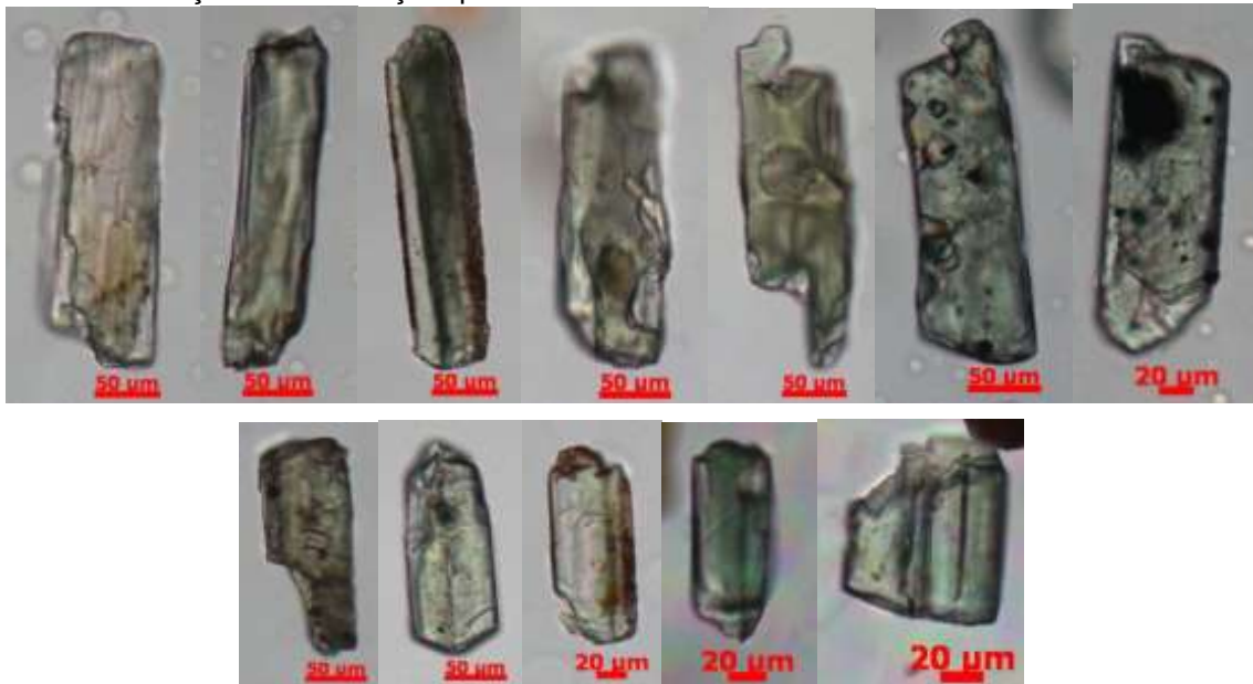
Figura 17 - Microfotografia, sob luz natural, dos grãos de hiperstênio, destacando prismas alongados e curtos, como também, destaque para feições de corrosão na superfície de alguns grãos, demonstrando feições de dissolução química.
