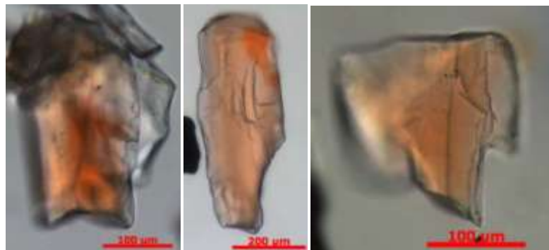
Figura 24 - Microfotografias, sob luz natural, dos grãos de andaluzita, destaque para grãos angulosos a subangulosos.
