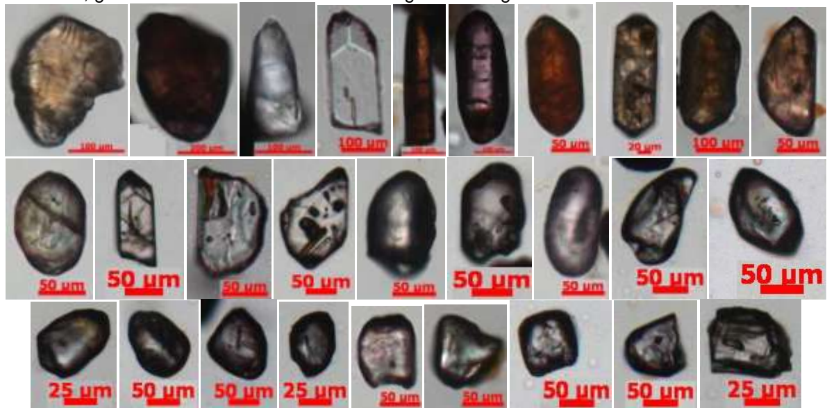
Figura 14 - Microfotografias, sob luz natural, dos grãos de zircão, ilustrando a grande variedade de formas ocorrentes nos sedimentos estudados, principalmente grãos prismáticos bipiramidais, subédricos, grãos subarredondados e também fragmentos angulosos.
