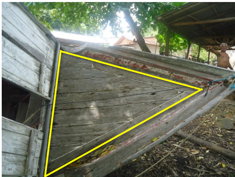
Figura 15: Forma triangular constituída na proa da embarcação. Fonte: Miranda, 2016.
