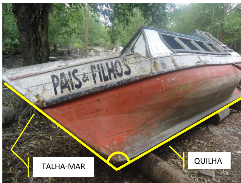
Figura 12: Aproximação de ângulo na união do talha-mar com a quilha.
