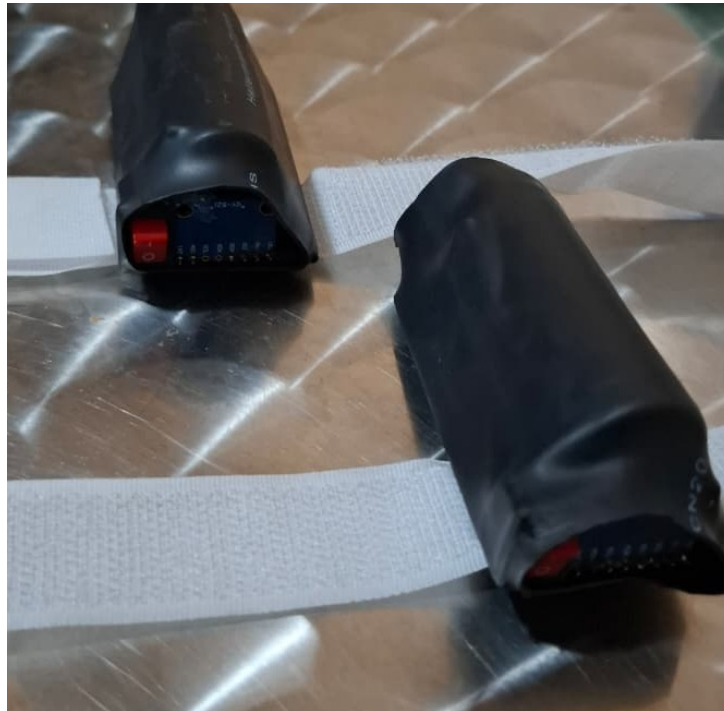
Figura 7 – Nós sensores, com velcro para a fixação e encapsulados com tubo termo retrátil para aumento da segurança mecânica e elétrica.
