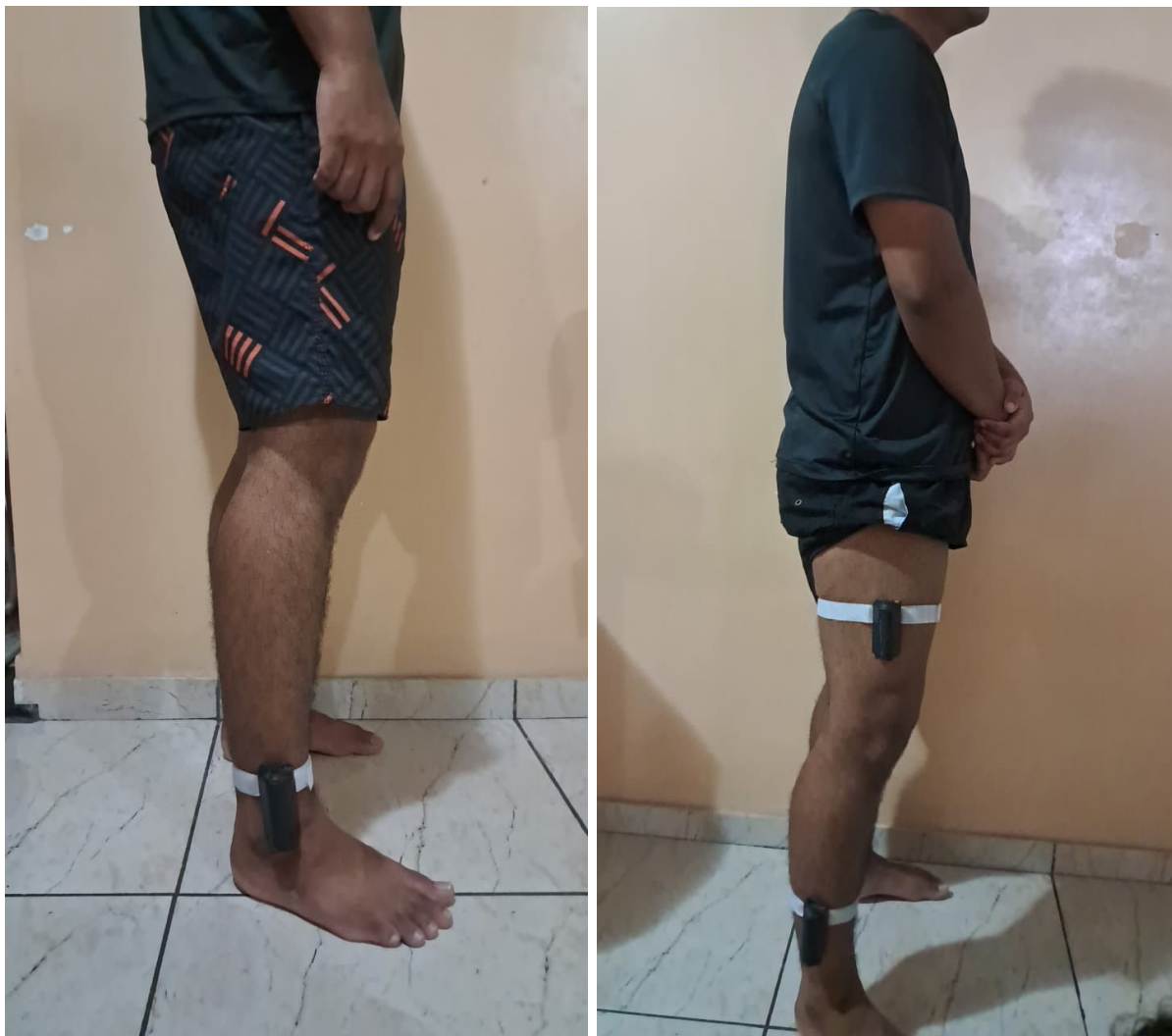
(a) Configuração com sensor único na perna para análise cinemática e extração de métricas temporais.
