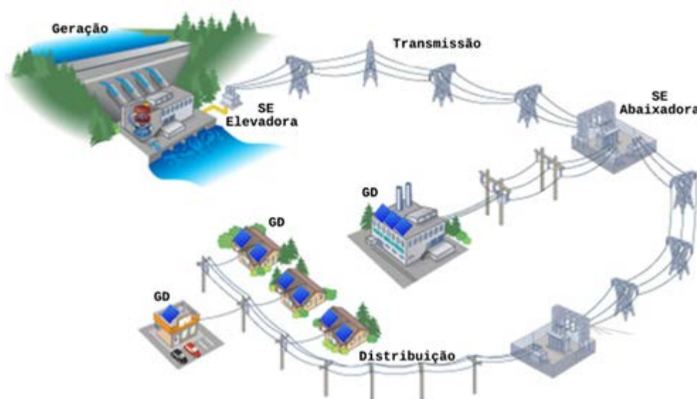
Figura 2.1 – Inserção da geração distribuída em sistema de distribuição
