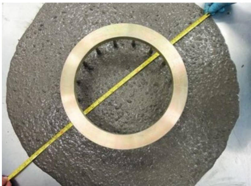
Figura 3: Ensaio J-Ring do concreto com seixo natural.
