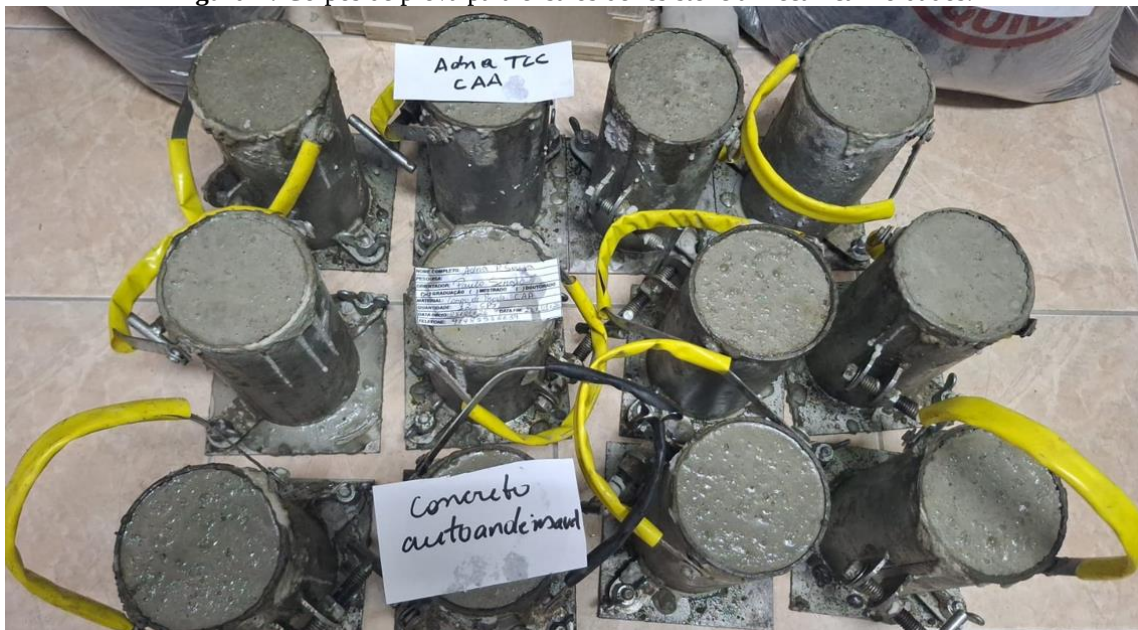
Figura 7: Corpos de prova para ensaios de resistência mecânica moldados.
