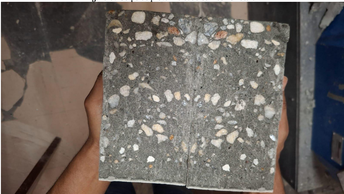
Figura 9: Corpo de prova moldado com seixo natural.
