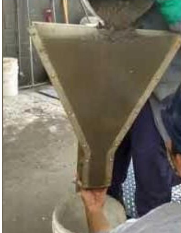
Figura 4: Ensaio V-Funnel do concreto com brita.
