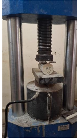
Figura 12: Corpo de prova moldado com seixo natural na prensa para o ensaio de resistência à tração por compressão diametral.
