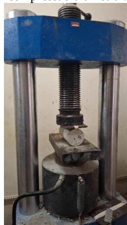
Figura 11: Corpo de prova moldado com brita 0 na prensa para o ensaio de resistência à tração por compressão diametral.
