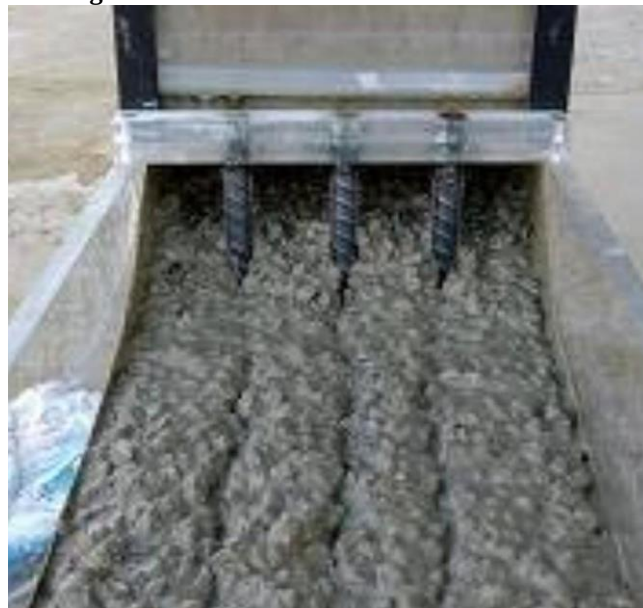
Figura 5: Ensaio L-Box do concreto com brita 0.
