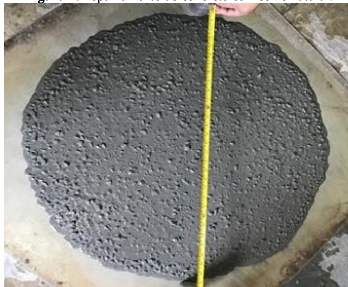
Figura 2: Espalhamento do concreto com seixo natural.
