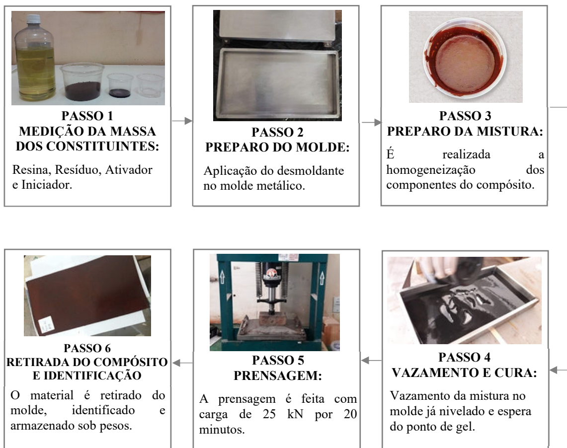
Figura 3.8 – Fluxograma simplificado da fabricação do compósito.
