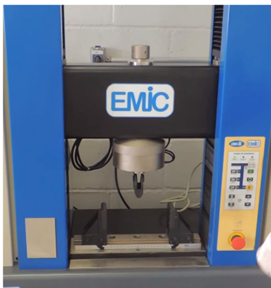
Figura 3.14 – Equipamento utilizado para o ensaio de flexão.
