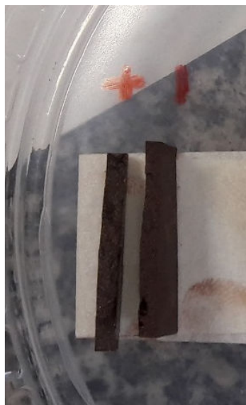
Figura 3.13 – Amostras de superfície de fratura para imagem no MEV.
