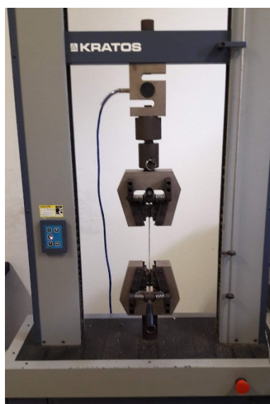
Figura 3.11 – Equipamento utilizado para o ensaio de tração.
