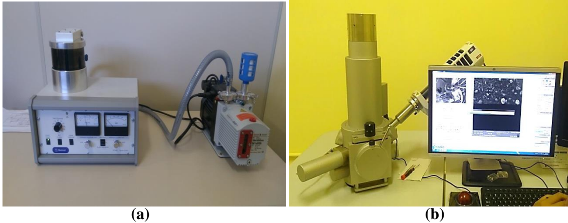
Figura 15 – (a) Equipamento para pulverização de ouro e evaporação de carbono e (b) Microscópio Eletrônico de Varredura
