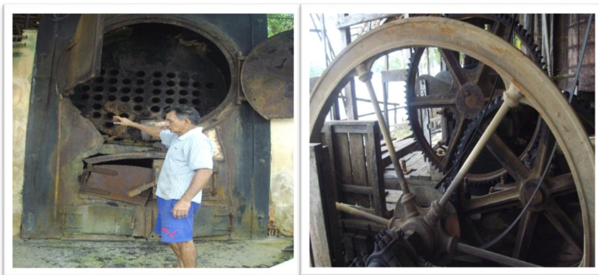
Fig. 11: Engenho Pacheco – Na fotografia o proprietário do engenho mostra e explica o funcionamento do forno – caldeira. Na outra foto aparece a maquina de moer – moinho - a cana, para tirar o que se chama de garapa, o caldo da cana. Essas máquinas já estão muito deterioradas, mas segundo o senhor, ainda podem funcionar visto que foram desativadas em 2011.
