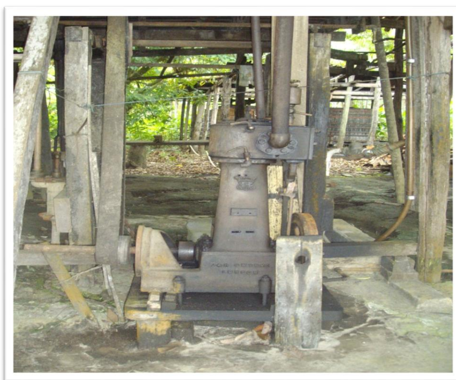
Fig 06: Engenho Pacheco - Máquina importada de Londres, Inglaterra. Essa máquina tinha a função de transportar, via tubos, a cachaça fermentada dos toneis e levá-la até o alambique. Isso mostra todo o investimento econômico para manter a boa e próspera produção de cachaça.
