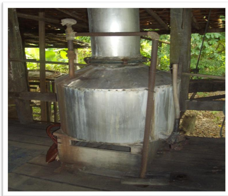
Fig.10 Engenho Pacheco: O Alambique que, segundo o proprietário, é a máquina mais importante e complexa da produção da cachaça. Destila a bebida levando para o tonel, pronta para o consumo.
