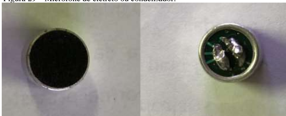
Figura 29 – Microfone de eletreto ou condensador.
