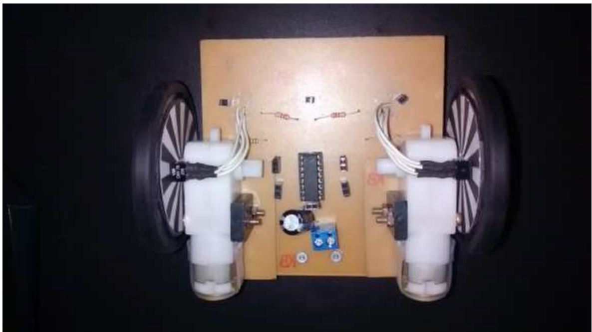
Figura 17: Frente da placa de circuito impresso, também utilizada como chassi.
